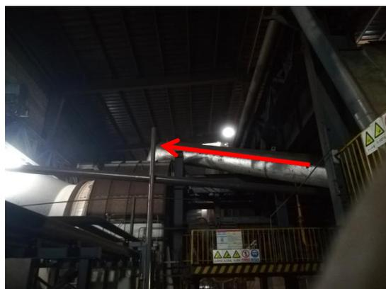
回转窑卸料 矿热炉进料废气回收至回转窑
